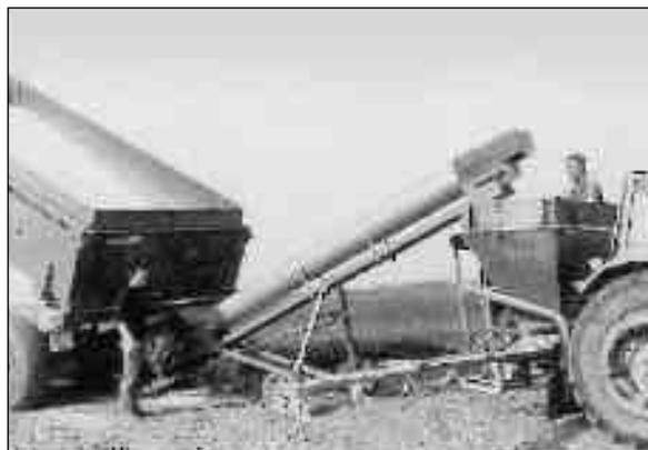
*Remplissage d'un distributeur d'engrais sans intervention manuelle.*
